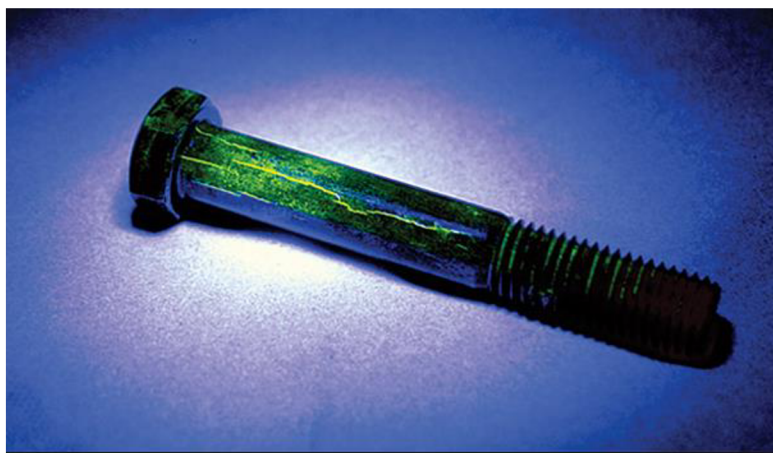
Obr. 3.5 Fluoreskacia chyby materiálu po ožiarení ultrafialovým svetlom [10]
