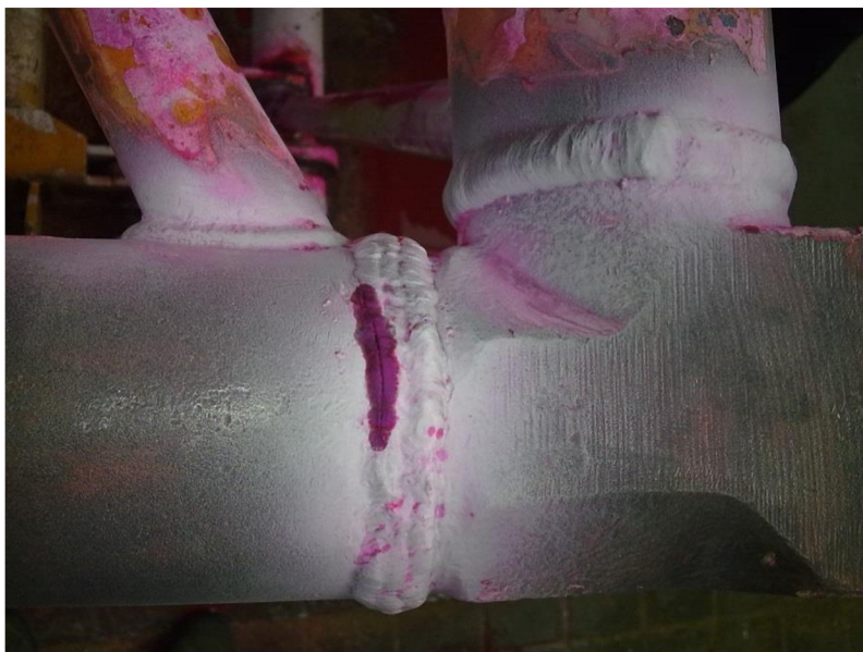
Obr. 3.3 Metóda farebnej indikácie pri určení vady zvarov [14]
