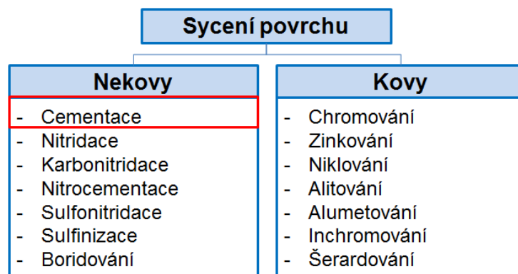
Obr. 2-5: Typy sycení povrchu dle sytícího prvku [1]
