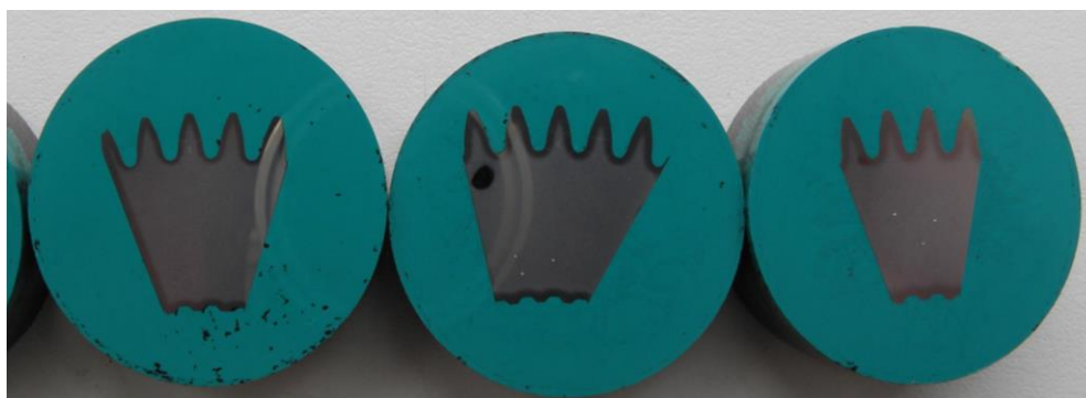
Obr. 3-3: Metalografické vzorky z hnacích kol 3. rychlosti
