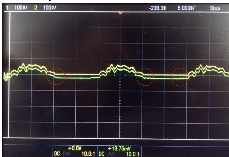
Obr. 6-6 Vliv kondenzátoru na výstupní signál. Žlutá sonda byla umístěna za kondenzátorem a zelená před ním. Červeně jsou označeny filtrovaná místa.
