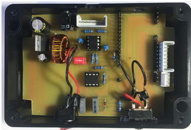
Obr. 5-2 Osazená pracovní deska a uložena v krabičce.
