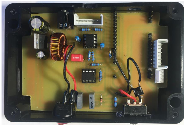
Obr. 5-2 Osazená pracovní deska a uložena v krabičce.
