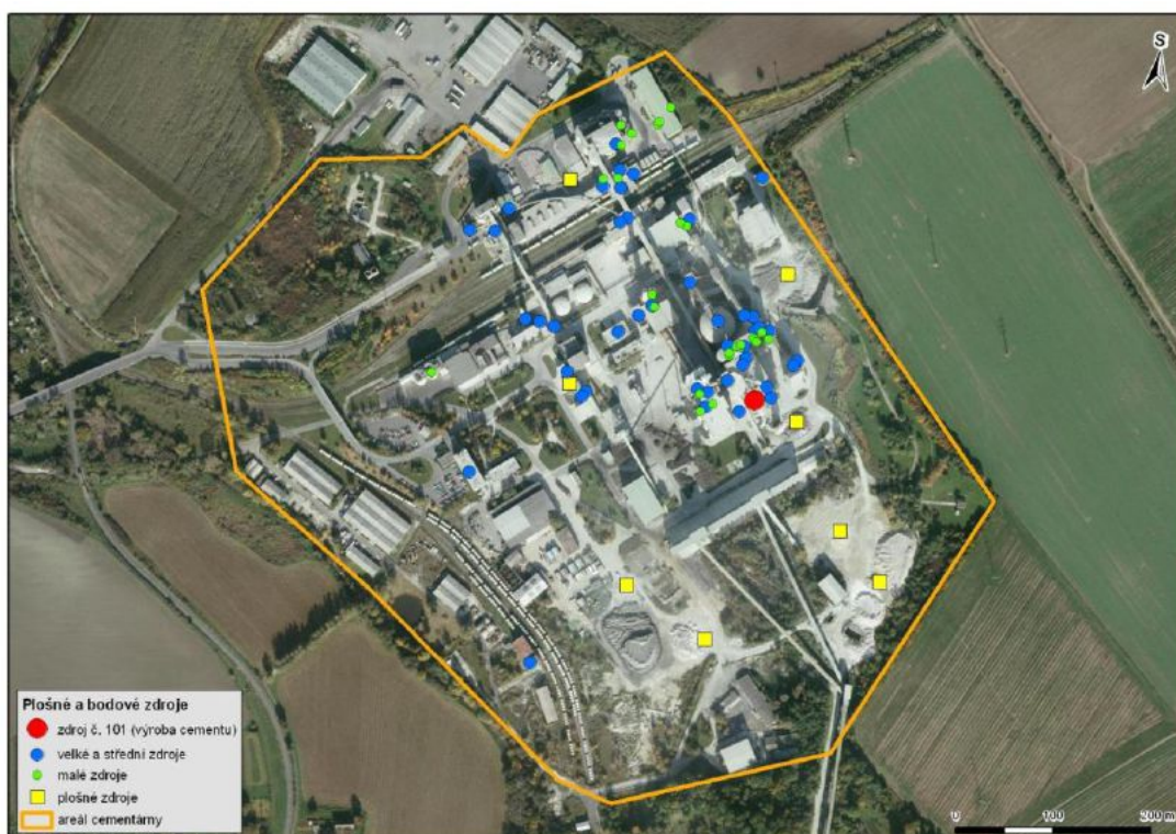
Obr. č. 26: Umístění zdrojů emisí v prostoru cementárny
