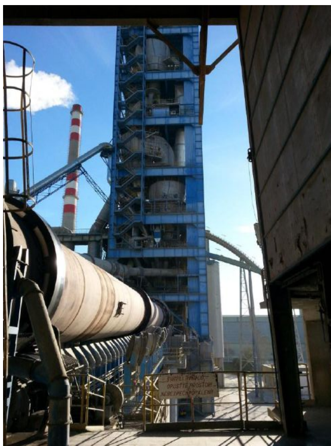
Foto č. 2: Pohled na rotační pec s výměníkem
