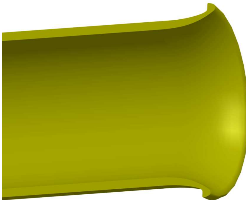
Obr 12.5 Průřez vstupu vzduchu do sání
