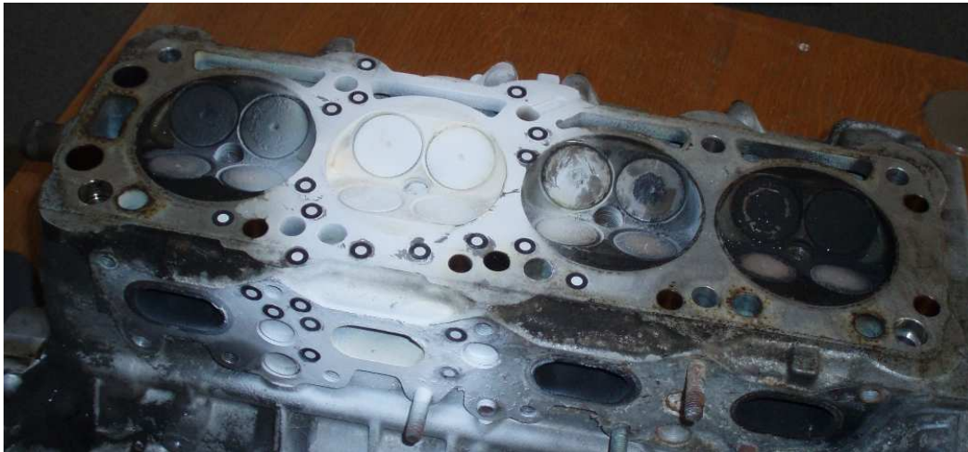
Obr. 7.3 Hlava motoru připravená na skenování
