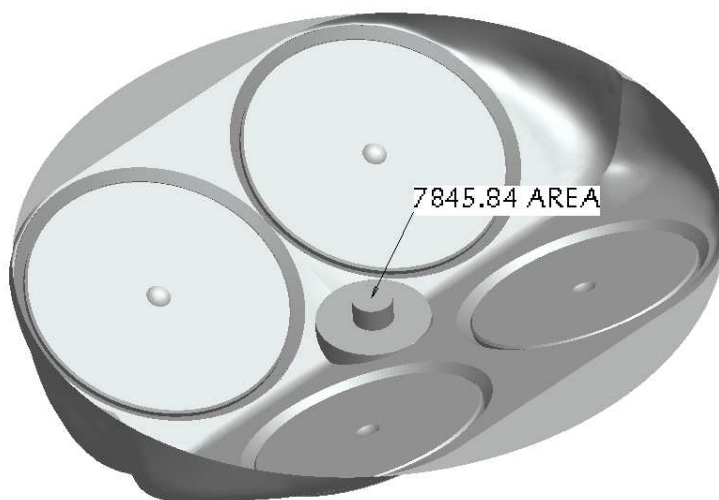
Obr. 7.5 Povrch plochy spalovacího prostoru
