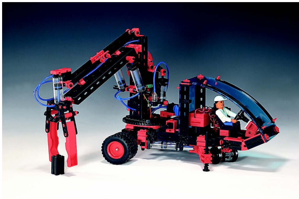
Obrázek 3 Ukázka robotu firmy Fischertechnik, pneumatická koncepce
