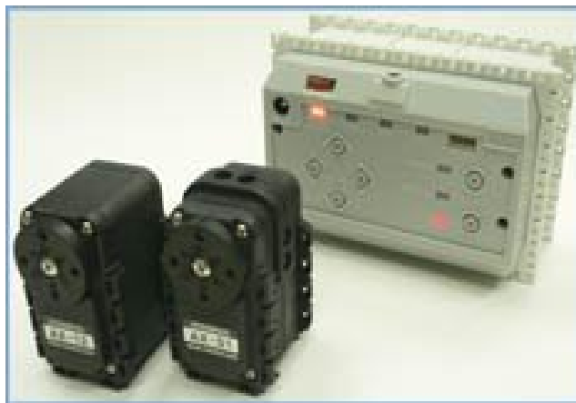
Obrázek 5 Pohonný modul AX-12, řídicí modul CM-5 a senzory AX-S1
