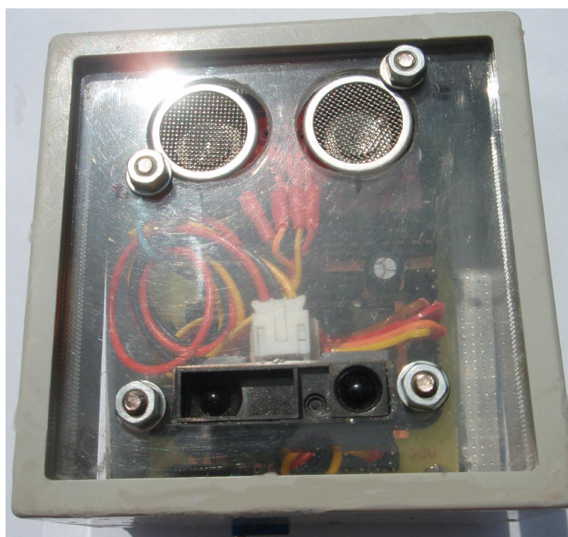
Obrázek 52 Obvod a senzory umístěné v krabičce
