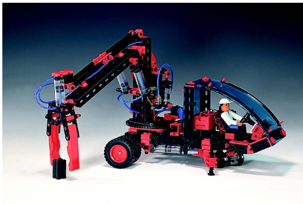
Obrázek 3 Ukázka robotu firmy Fischertechnik, pneumatická koncepce
