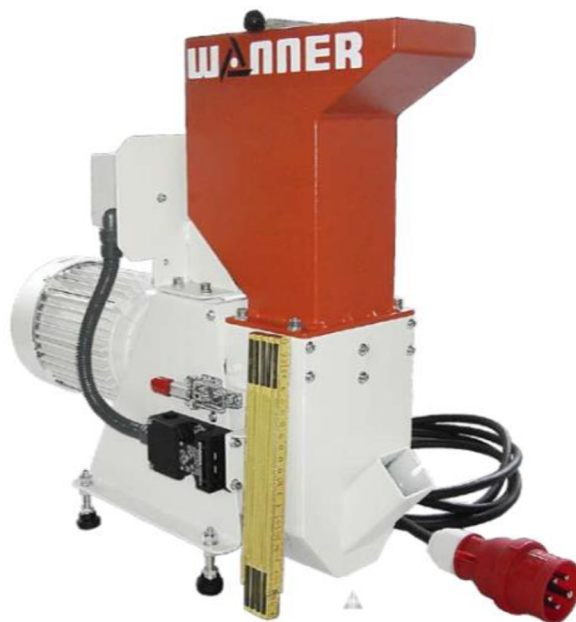
Obrázek 10 - Nožový mlýn (Zdroj: Wanner mlýn řady B08.10 Standard, 2023)
