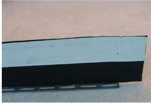
Obrázok 36 - Krycia fólia plechu (odlepenie) [10]
