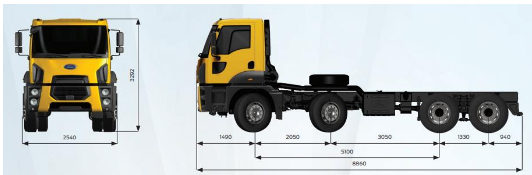
Obrázok 61 - Rozmery auto domiešavaču Ford Trucks 4142M [28]
