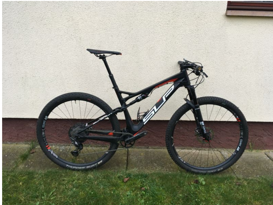
obrázek 4: Moderní celoodpružené kolo s teleskopickou sedlovou a 29 palcovými koly ( zdroj: vlastní )
