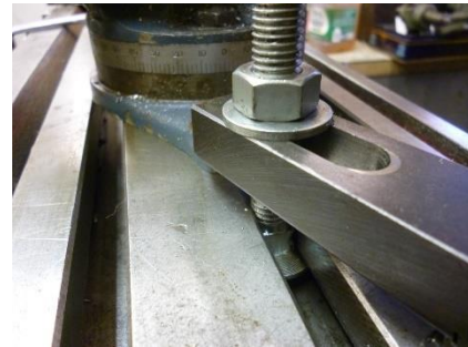
Obr. 22 Upnutí upínky k pracovní ploše [48].
