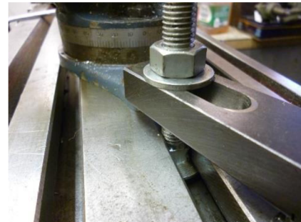
Obr. 22 Upnutí upínky k pracovní ploše [48].
