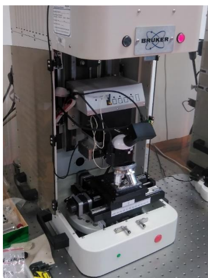
Obrázek 35: Scratch tester Bruker CETR-Apexod výzkumného centra CxI TUL
