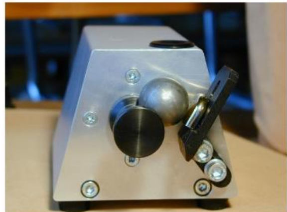
Obrázek 8: Vlevo: měření tloušťky vrstvy metodou Kalotest – kulička
