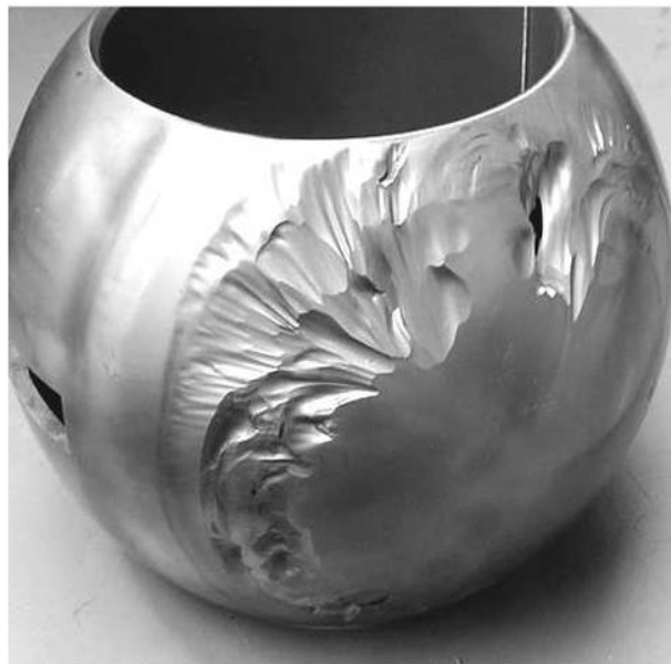
Obrázek 8: Kulový uzávěr opotřebený erozí [32]
