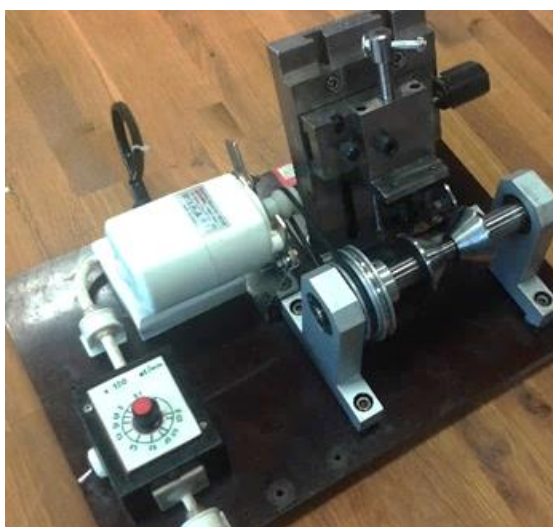
Obrázek 37: Zařízení Kalotest v laboratořích výzkumného centra CxI TUL.
