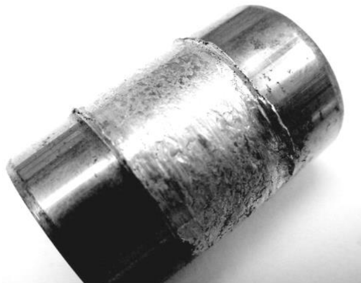
Obrázek 5: Adhezivní opotřebení na čepu pístu. [32]
