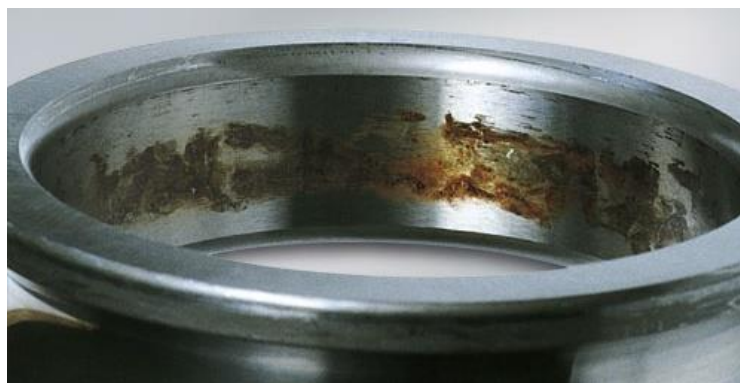
Obrázek 10: Vibrační opotřebení vnitřního kroužku ložiska uvolněného na hřídeli [38]
