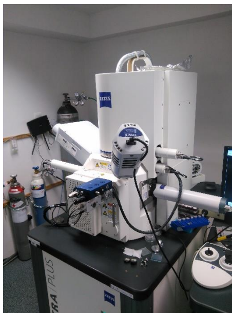
Obrázek 19: SEM v laboratořích katedry materiálů.
