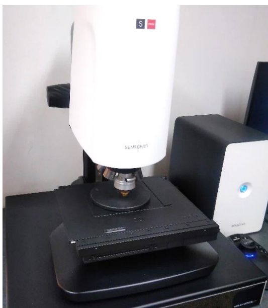
Obrázek 40: Konfokální mikroskop firmy Sensofar metrology na katedře materiálu TUL
