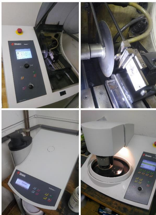
Obrázek 26: Metalografické vybavení Struers: a) metalografická pila, b) detail s upnutým vzorkem, c) lis, d) automatická bruska.
