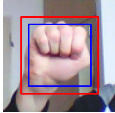
Obrázek 5.4: Zmena veľkosti bounding boxu pri inicializácii trackeru. Červeným obdĺžnikom je označený výstup detektoru, modrým bounding box, ktorým je inicializovaný tracker.
