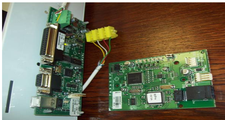
Obr. 19 Detail testovacího zařízení – pohled na modul IP100 a komunikační modul PRTX3
