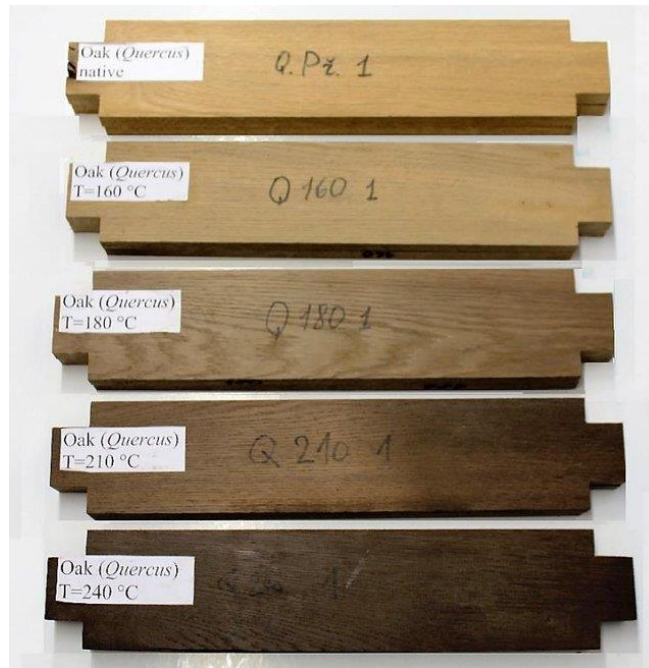
Obr. 12. Vliv stupňů termické úpravy na barvu dřeva dubu (www.researchgate.net)
