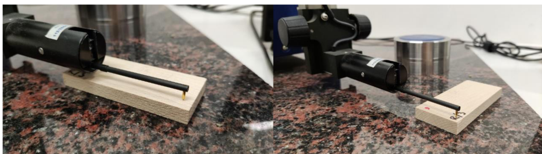
Obrázky č. 13 a 14 Měření drsnosti kontaktním profilometrem ve směru podél vláken (obr. vlevo) a napříč vláken (obr. vpravo)
