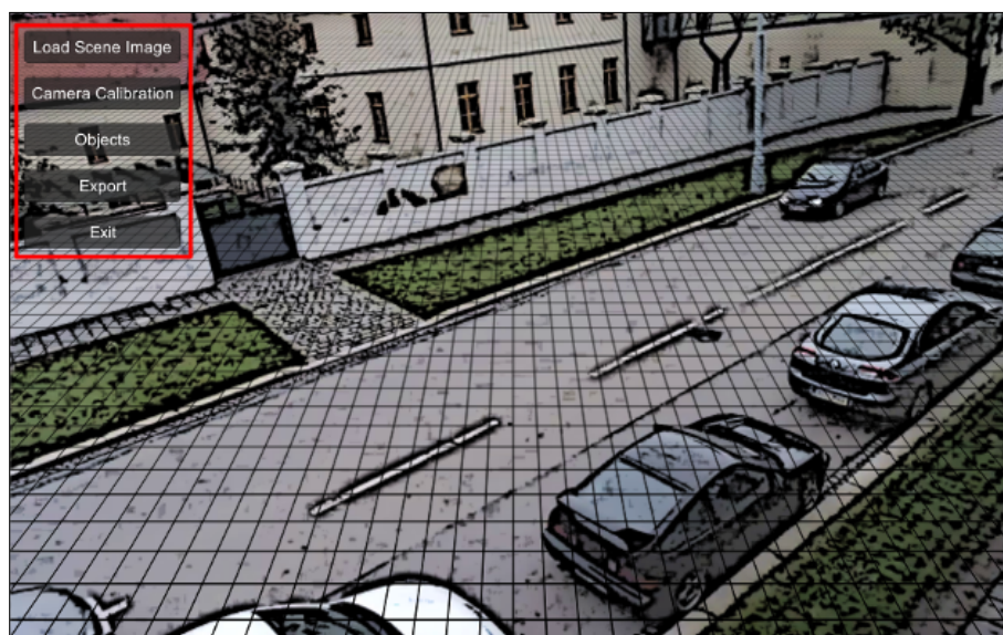
Obrázek 4.2: Editor scény po spuštění. Hlavní nabídka je zvýrazněna červeně. Load Scene Image – načtení jiného screenshotu scény, Camera Calibration – podmenu pro kalibraci/umístění kamery, Objects – podmenu pro anotaci, Export – exportování scény, Exit – opustit editor
