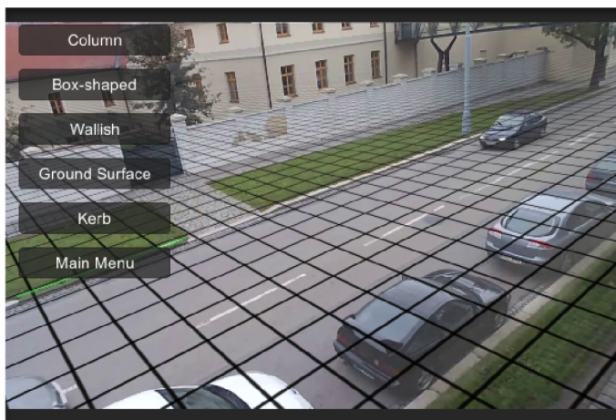
Obrázek 4.12: Nabídka pro tvorbu objektů: Column – sloup; Box-shaped – objekty ve tvaru kvádrů; Wallish – zdi/vertikální plochy; Ground Surface – povrchy; Kerb – obrubník; Main Menu – návrat do hlavní nabídky.
