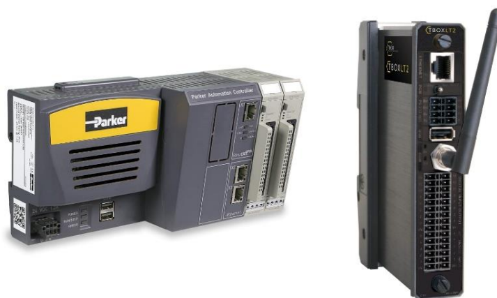
Obrázek 10 PAC (vlevo) [41] a RTU (vpravo) [42]
