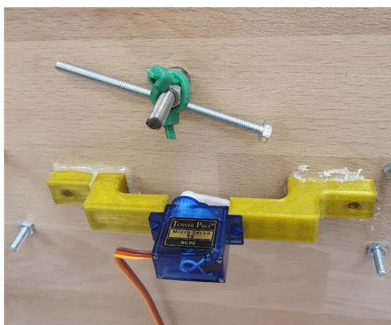
Obrázek 30 Uchycení a propojení servomotoru s třídící klapku
