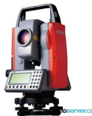
Obr. 38- Totální stanice PENTAX R-415N [52]
