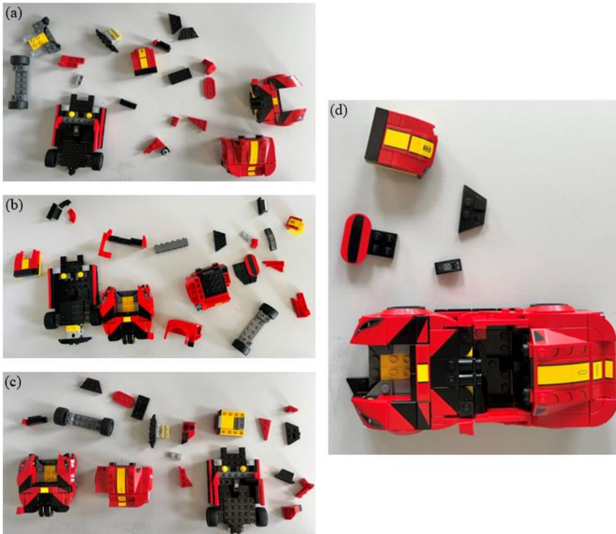
Obr. 48 Vplyv použitého modelu LEGO® Ferrari 812 Competizione pri náraze s dĺžkou dráhy 1 m: (a) opotrebovaný model – prvý pokus, (b) opotrebovaný model – druhý pokus, (c) opotrebovaný model – tretí pokus, (d) nový model
