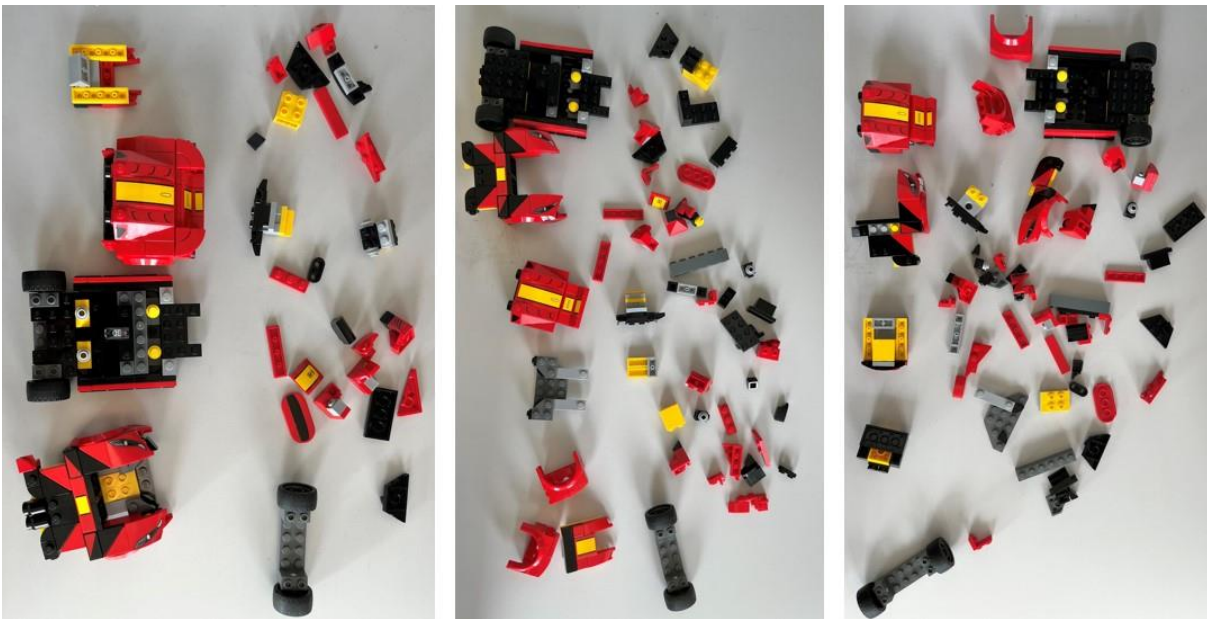
Obr. 44 Vplyv opakovateľnosti rozpojenia opotrebovaného modelu LEGO® Ferrari 812 Competizione pri dĺžke dráhy 1,6 m: naľavo prvý, v strede druhý a napravo tretí pokus opakovania
