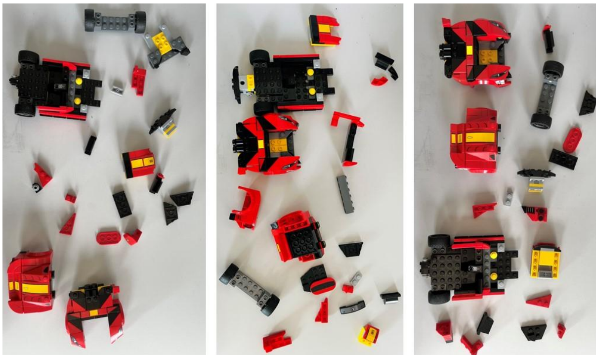
Obr. 45 Vplyv opakovateľnosti rozpojenia opotrebovaného modelu LEGO® Ferrari 812 Competizione pri dĺžke dráhy 1 m: naľavo prvý pokus, v strede druhý a napravo tretí pokus opakovania
