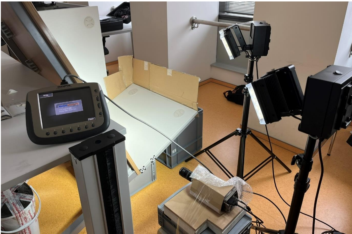
Obr. 43 Rozloženie meracej techniky okolo nárazovej konštrukcie
