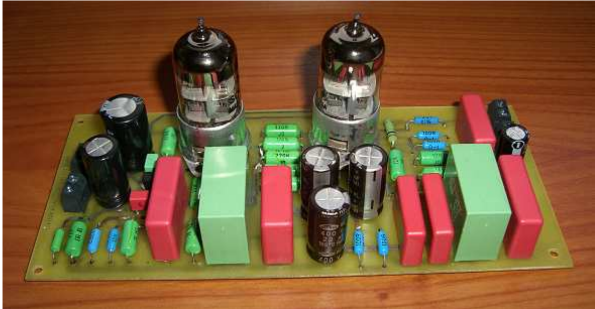
Obr. 20. Foto osazeného korekčního pravého kanálu
