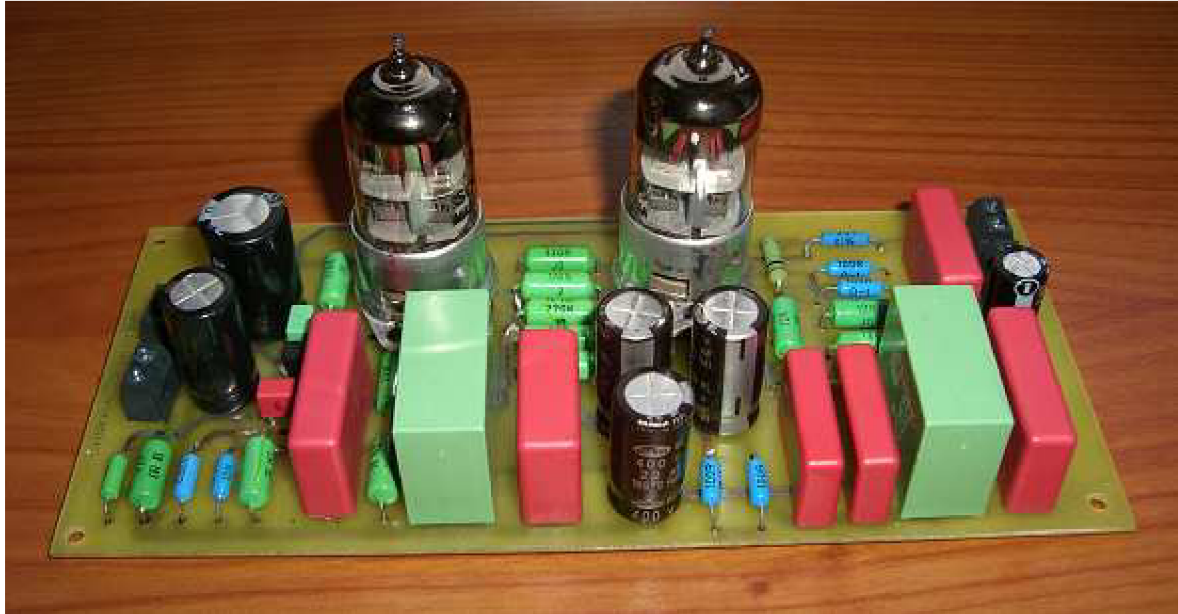
Obr. 20. Foto osazeného korekčního pravého kanálu
