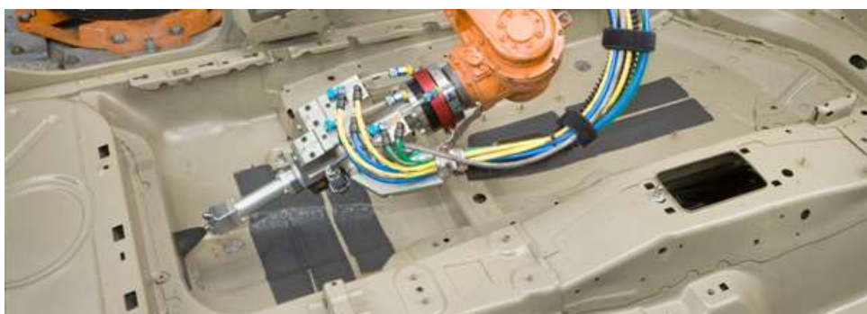
Obr. 59 Schéma aplikace tlumícího materiálu značky Henkel [32]
