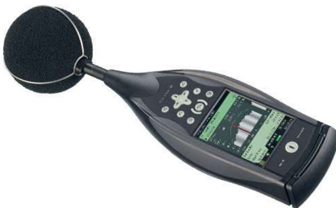
Obr. 13 Hlukoměr Brüel & Kjaer typu 2270 s jedním mikrofonom [17]
