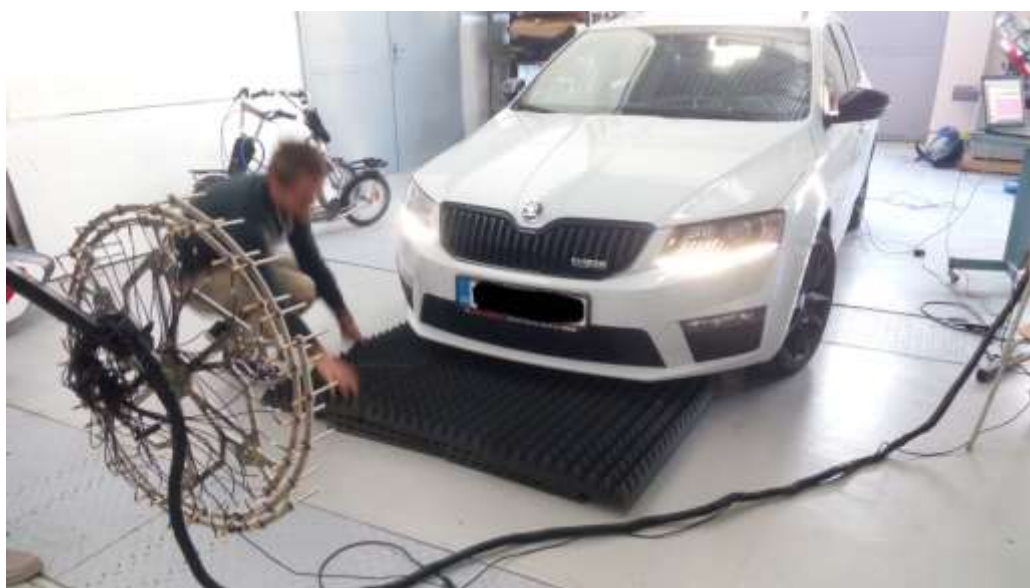
Obr. 25 Měření hluku pomocí akustické kamery
