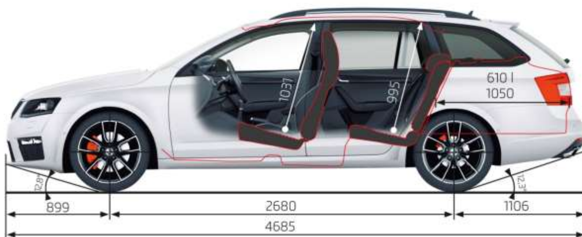
Obr. 34 Model vozu Škoda Octavia combi RS třetí generace s vnějšími rozměry [38]
