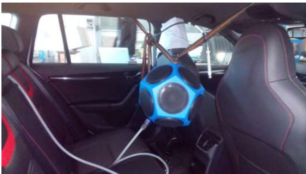
Obr. 23 Umístění všesměrového zdroje a referenčního mikrofonu uvnitř automobilu
