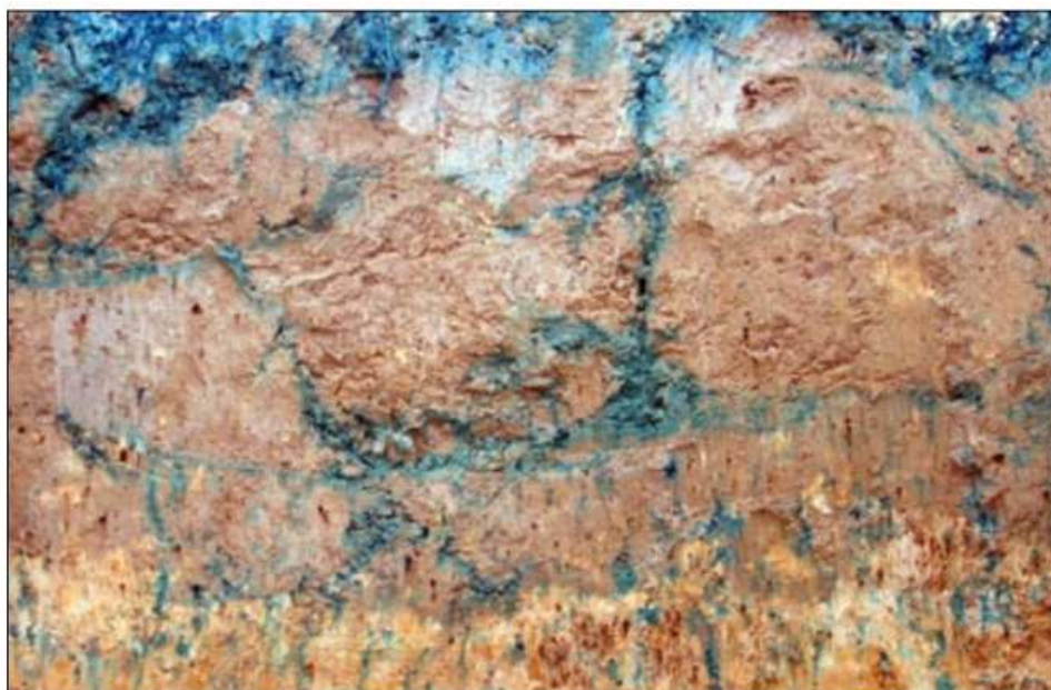
Obr. č. 5: Znárodnění preferenčních cest s využitím traceru „E 330 – brilantní modř“ (Převzato z: Kovaříček et al. , 2010)
