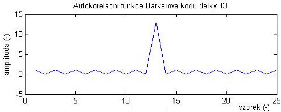
Obrázek 4.2.2: Průběh autokorelační funkce Barkerova kódu délky 13
