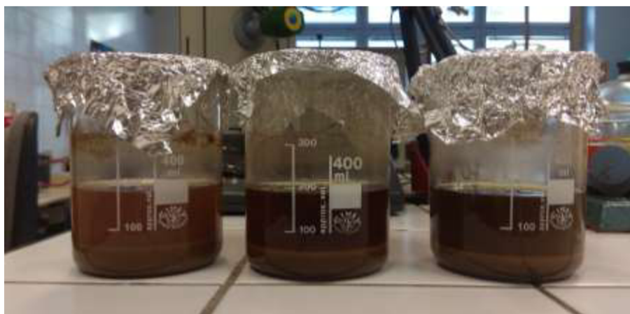
Obrázek 13: Extrakty drcených semen révy vinné před filtrací macerované 12 dní ve vybraných koncentracích ethanolu, 30% ethanol (vlevo), 50% ethanol (uprostřed) a 70% ethanol (vpravo)
