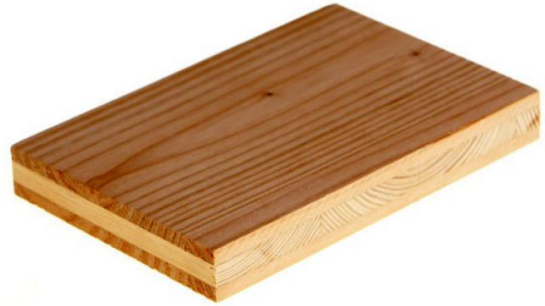
Obr. 3 Třívrstvá deska z masivního dřeva – biodeska (Böhm et al., 2012)
