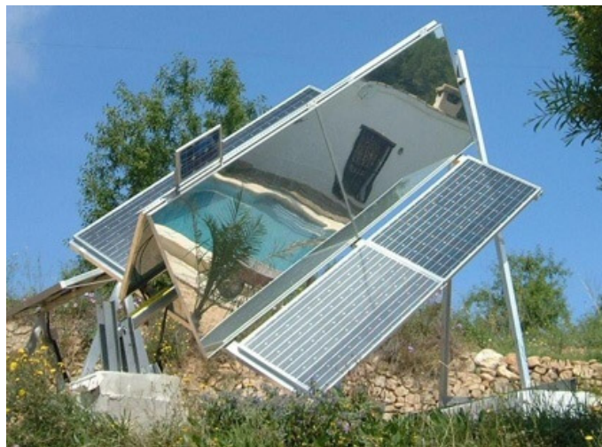
Obr. 4.11 Pohyblivý solární panel instalovaný ve Španělsku (500W) [28]
