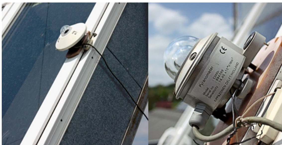
Obr. 3.5. Pyranometr 2 – měření dopadajícího slunečního záření na skloněnou plochu
