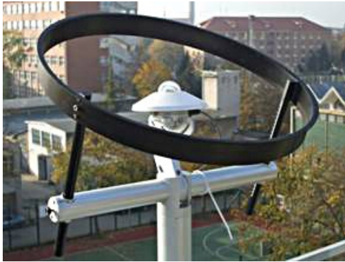
Obr. 2.4 Měření difúzní složky záření pomocí kruhové clony [15]
