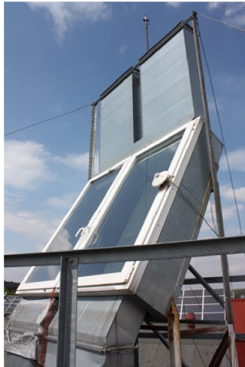
Obr. 3.1 Solární komín - externí část
