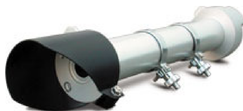
Obr. 2.5 Pyrheliometr (měření přímého záření) [16]
