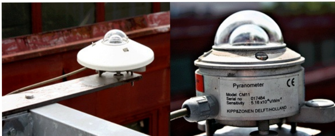
Obr. 3.4 Pyranometr 1 – měření dopadajícího solárního záření na vodorovnou plochu
