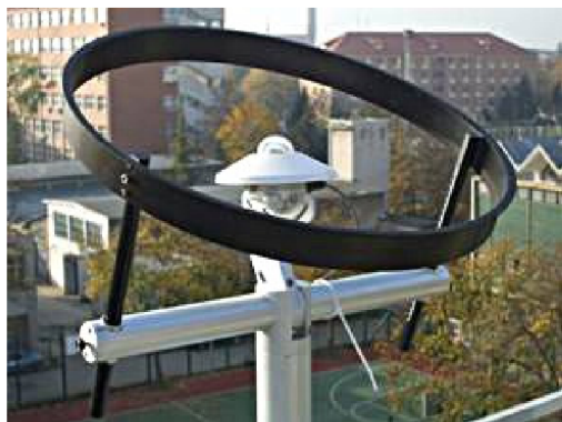
Obr. 2.4 Měření difúzní složky záření pomocí kruhové clony [15]
