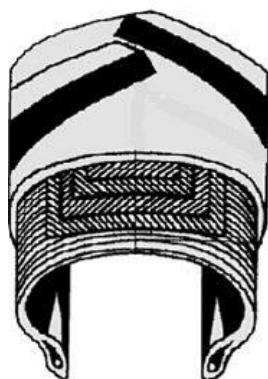
Obrázek 2: Řez radiální pneumatikou (Upraveno: Reimpell et al.,2009)
