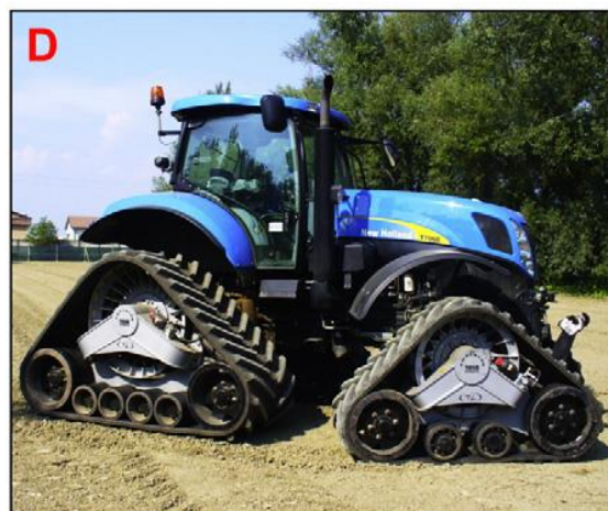
Obrázek 4: čtyři různé konfigurace pojezdů u traktoru New Holland T7060 (upraveno: Molari et al., 2011)
