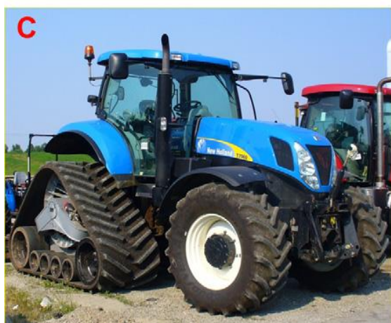
Obrázek 4: čtyři různé konfigurace pojezdů u traktoru New Holland T7060 (upraveno: Molari et al., 2011)
