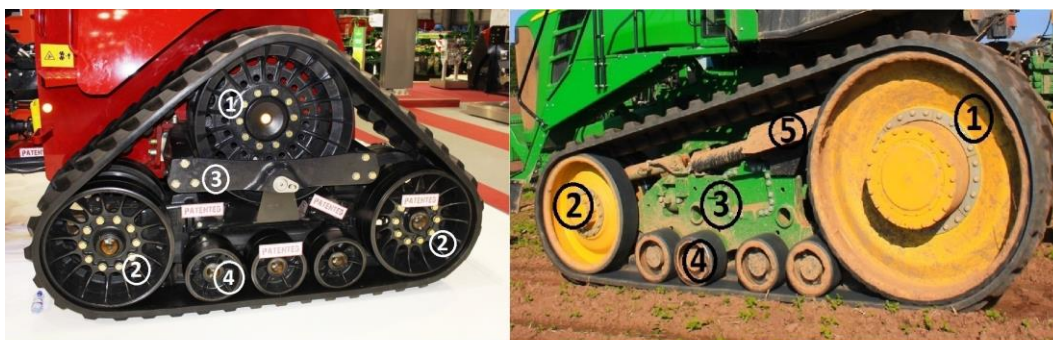
Legenda: 1 - hnací kolo, 2 - napínací kola, 3 - centrální nosník, 4 - středové vodící kladky, 5 - napínací mechanismus
