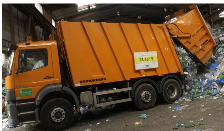
Obr. 11: Svážecí vůz s lineárním lisováním [27]
