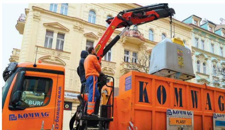
Obr. 12: Svážecí vůz s kontejnerem a hydraulickou rukou [26]
