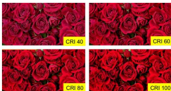
Obr. 10: Variance barevného vjemu osvětleného zdroji s různými indexy podání barev. [28]
