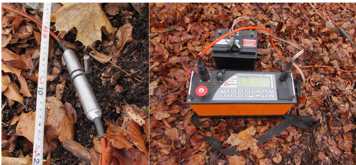
Obr. 13. Přístroj ARES; část multielektrodového kabelu, nerezová elektroda (trn), řídicí jednotka, T-kus, externí baterie
