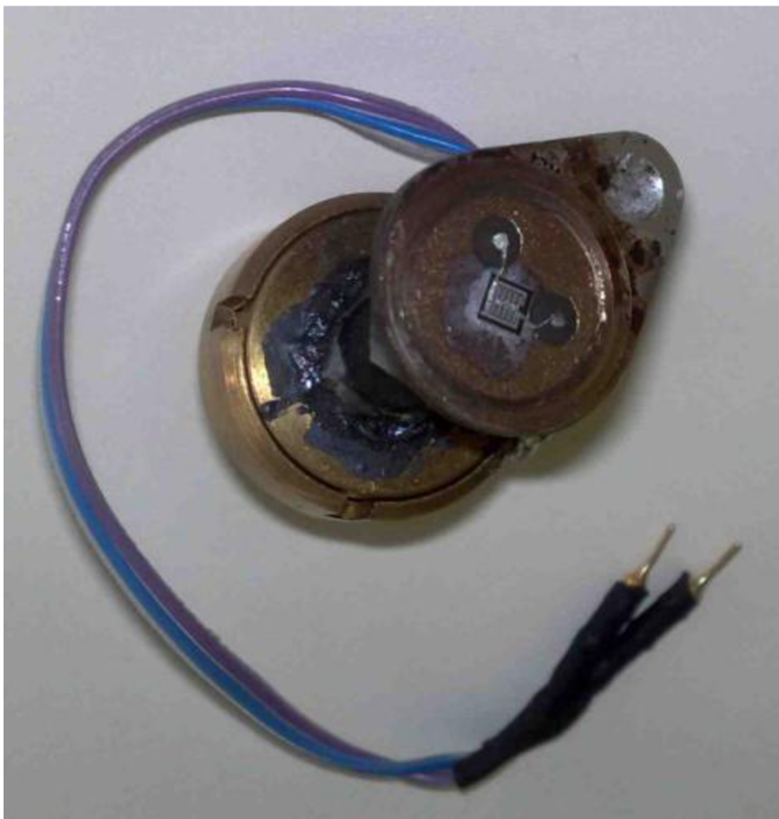
Obr. 49: Bipolární tranzistor NPN použitý pro měření napěťového kontrastu [7]
