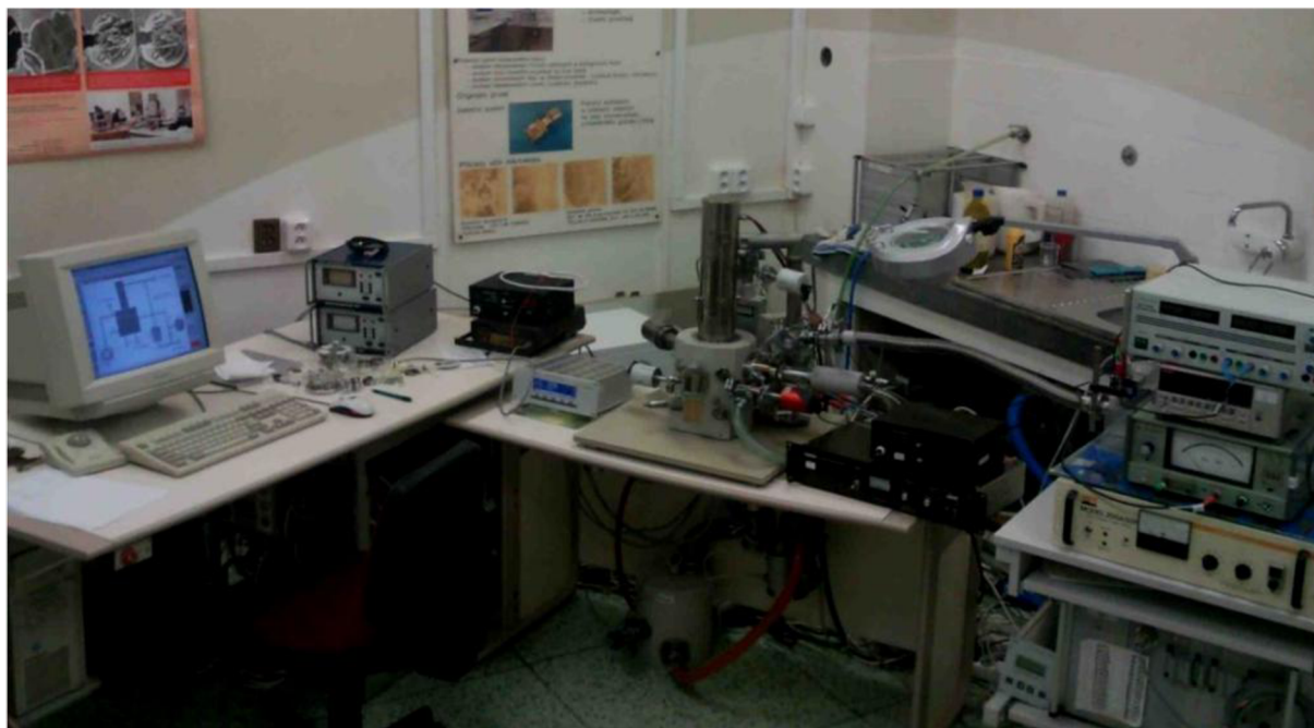
Obr. 23: Pracoviště s environmentálním rastrovacím elektronovým mikroskopem typu Aquasem I od firmy Tescan [7]
