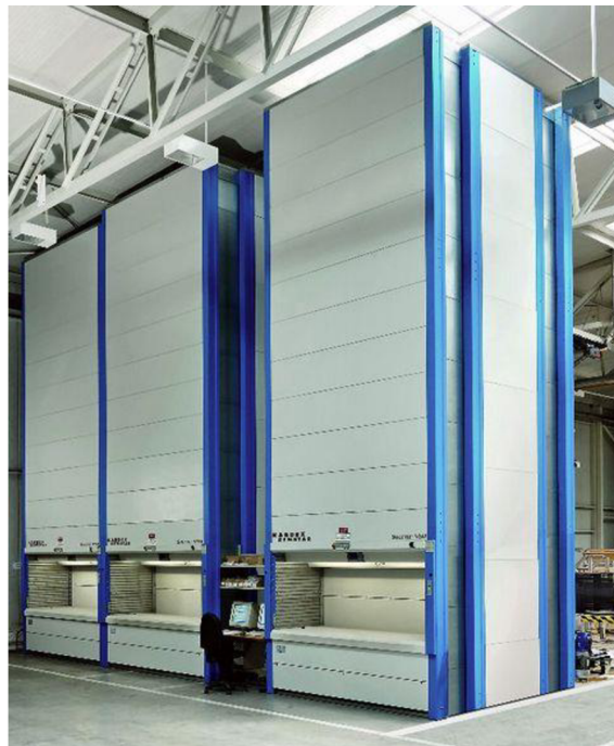
Obrázok 3 Vertikálny výtahový systém Kardex
