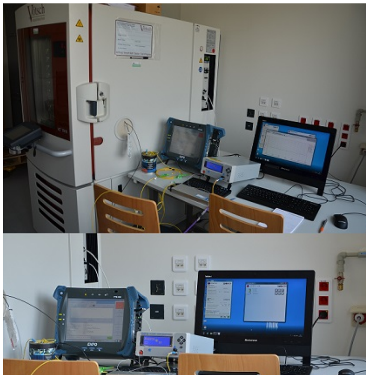
Obr. 6.27: Ukážka zapojenia do analyzátora a zdroja žiarenia.
