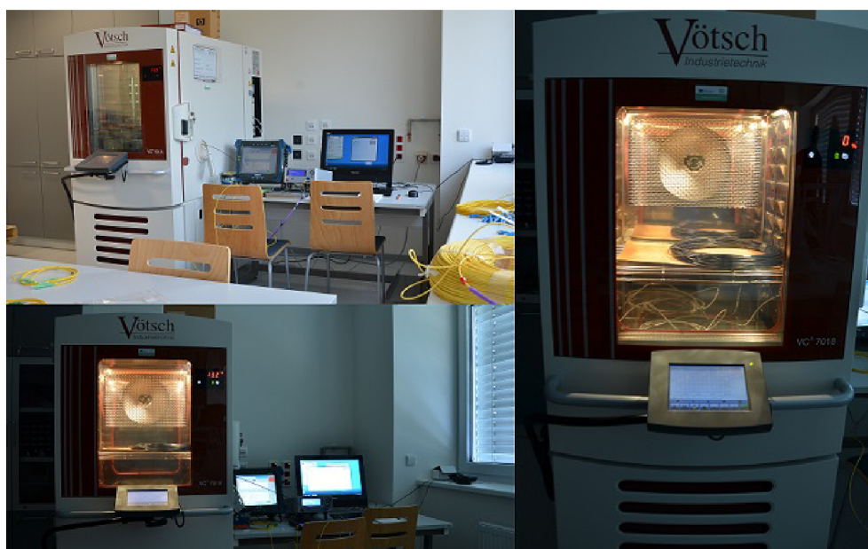
Obr. 6.25: Ukážka zapojenia pracoviska a teplotnej komory (vo vnútri meraná vzorka vlákna G.657).
