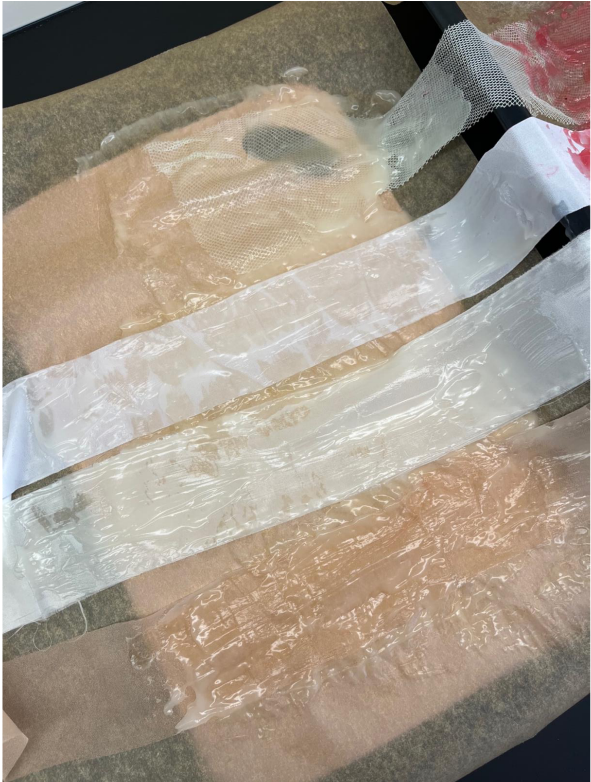
reakce vybraných textilií po namočení v bioplastu
