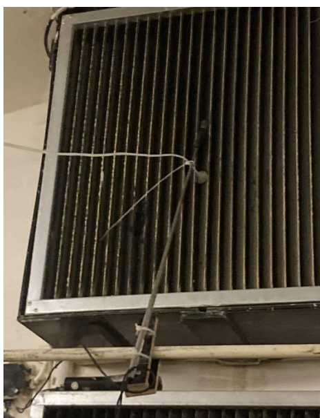
Obrázek 3.3: Ventilace a upevnění sondy Testo 435
