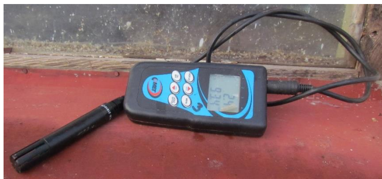
Obrázek 3.2: Termohydrobarometr Commeter D4141
