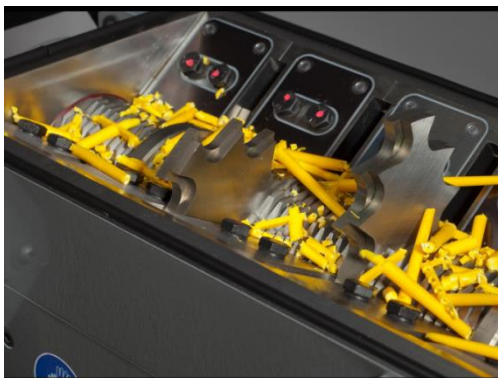
Obr. 6 Nožový mlýn, zdroj vlastní
