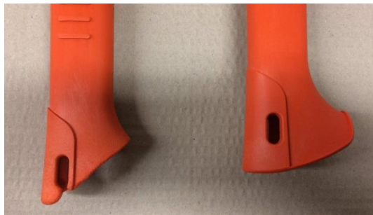
Obr. 9 Porovnání zmetku vlevo a dobrého plastového dílu vpravo, zdroj vlastní
