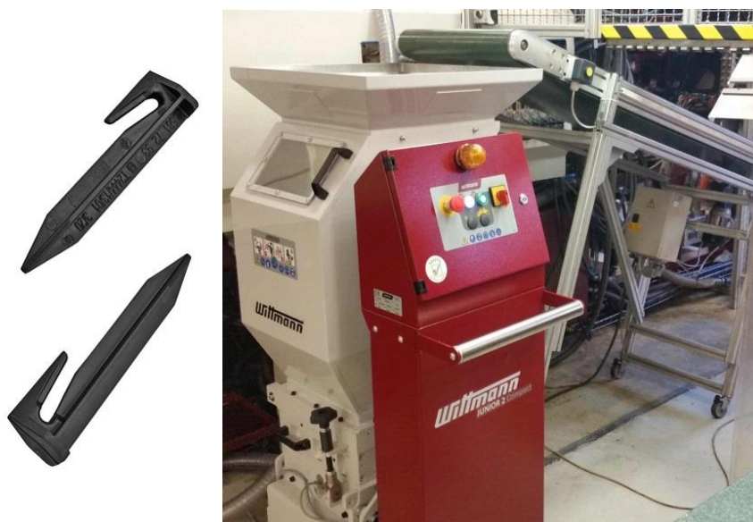
Obr. 11 Výrobek „hřebík“ zpracováváný mletím přímo u stroje, zdroj vlastní
