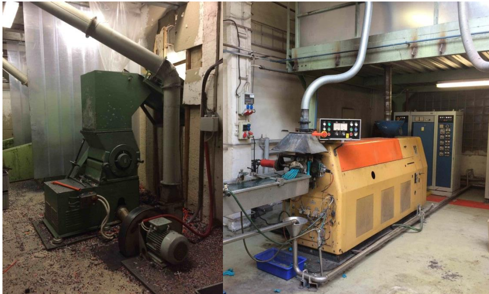
Obr. 10 Mletí a granulace mimo vstřikovací stroj, zdroj vlastní
