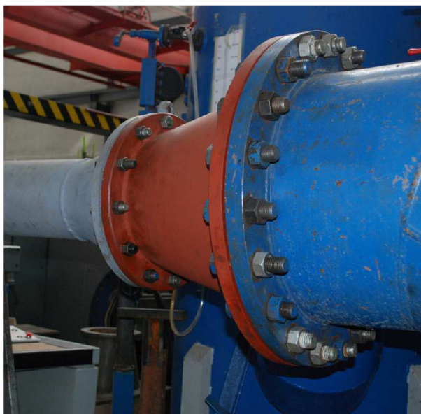
Obr. (5.7) Napojení přívodního potrubí modelu (šedé) na koleno DN400 (modré)
