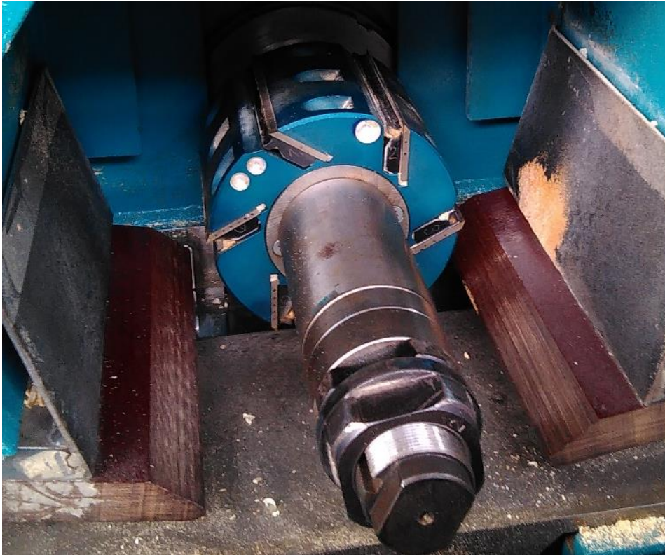
Obr. 33 – Fréza Benmet osazená ve standu.
