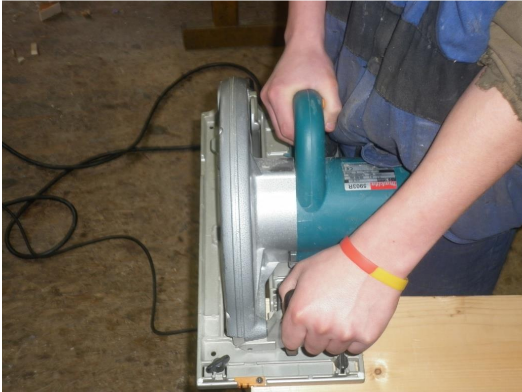
Obr 25: Držení ruční elektrické kotoučové pily pravákem (vlastní tvorba)
