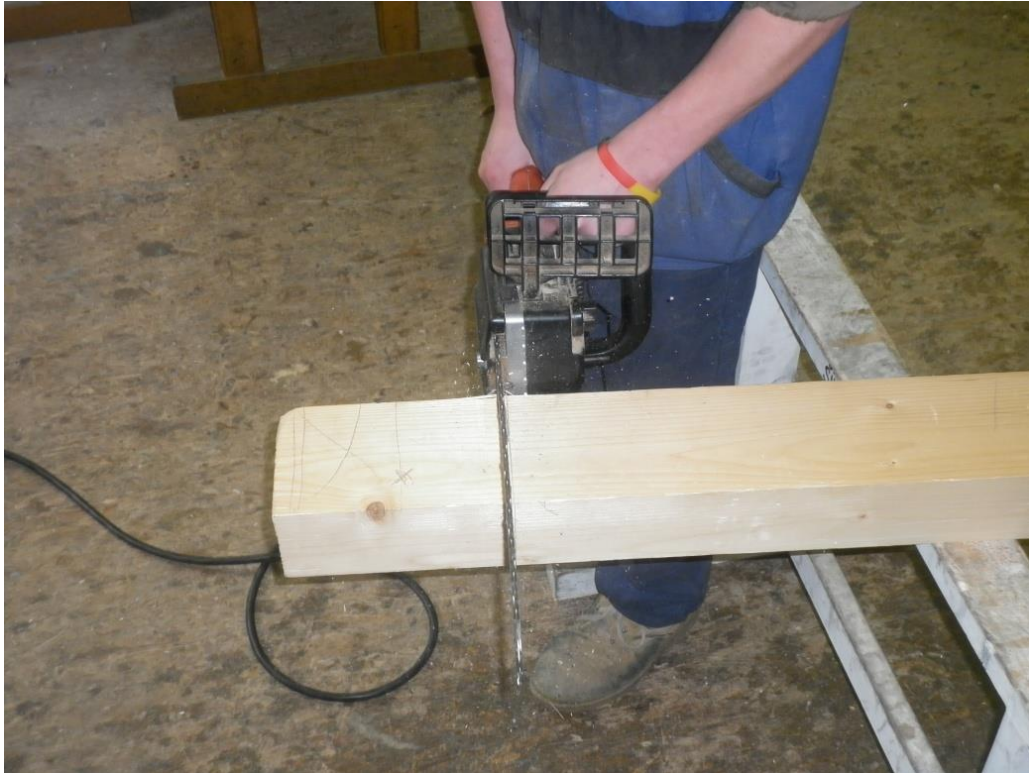
Obr 21: Postoj a držení elektrické řetězové pily pravákem (vlastní tvorba)
