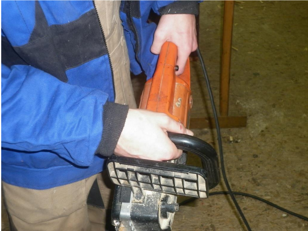
Obr 23: Detail držení řetězové pily levákem (vlastní tvorba)
