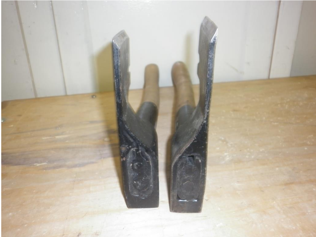
Obr 9: Vlevo levostranná a vpravo pravostranná sekera podbíječka – tvar a ostří (vlastní tvorba)
