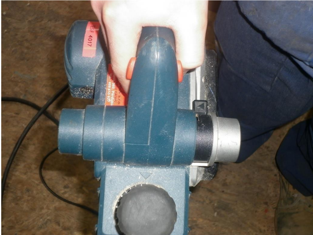
Obr 35: Oboustranné ovládání a odvod třísek u elektrického ručního hoblíku (vlastní tvorba)
