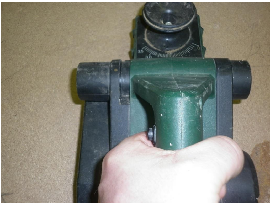
Obr 34: Přístup k ovládání leváka na ručním elektrickém hoblíku (vlastní tvorba)
