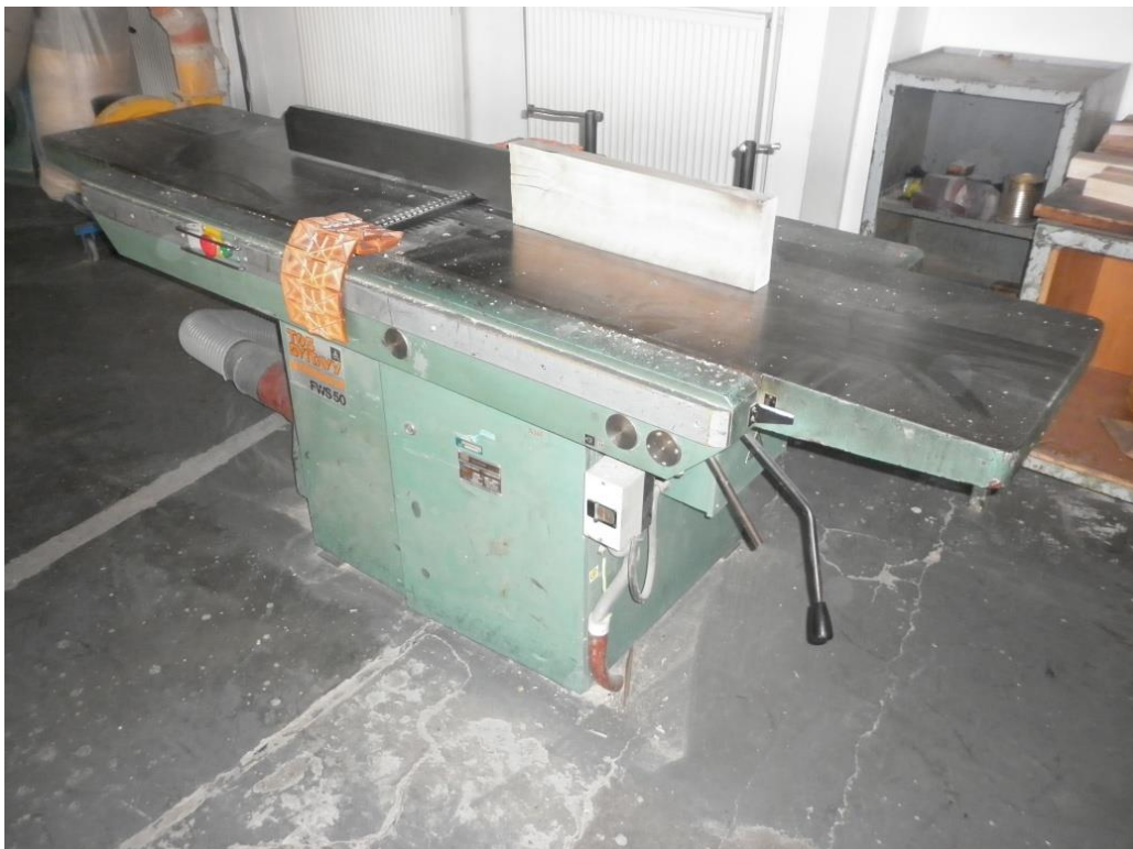
Obr 36: Srovnávací fréza s obsluhou z pravé strany (vlastní tvorba)
