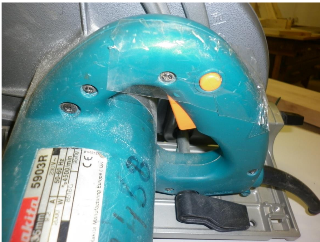
Obr 29: Úprava vypínače izolepou na kotoučové pile (vlastní tvorba)
