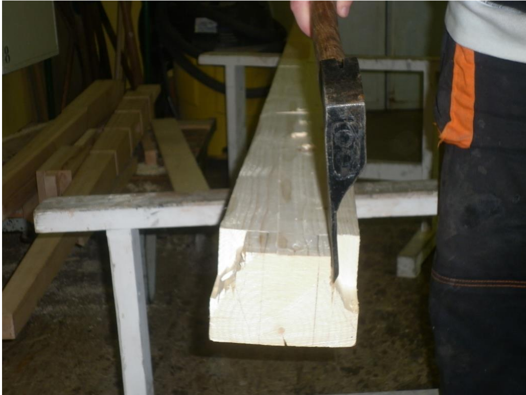
Obr 13: Jednoruční pravostranné použití, sekera podbíječka – vysekávání čepů (vlastní tvorba)
