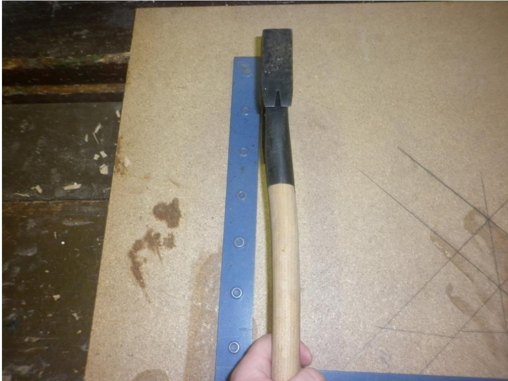
Obr 11: Sekera podbíječka při jednoručním levostranném držení – tvar topůrka (vlastní tvorba)
