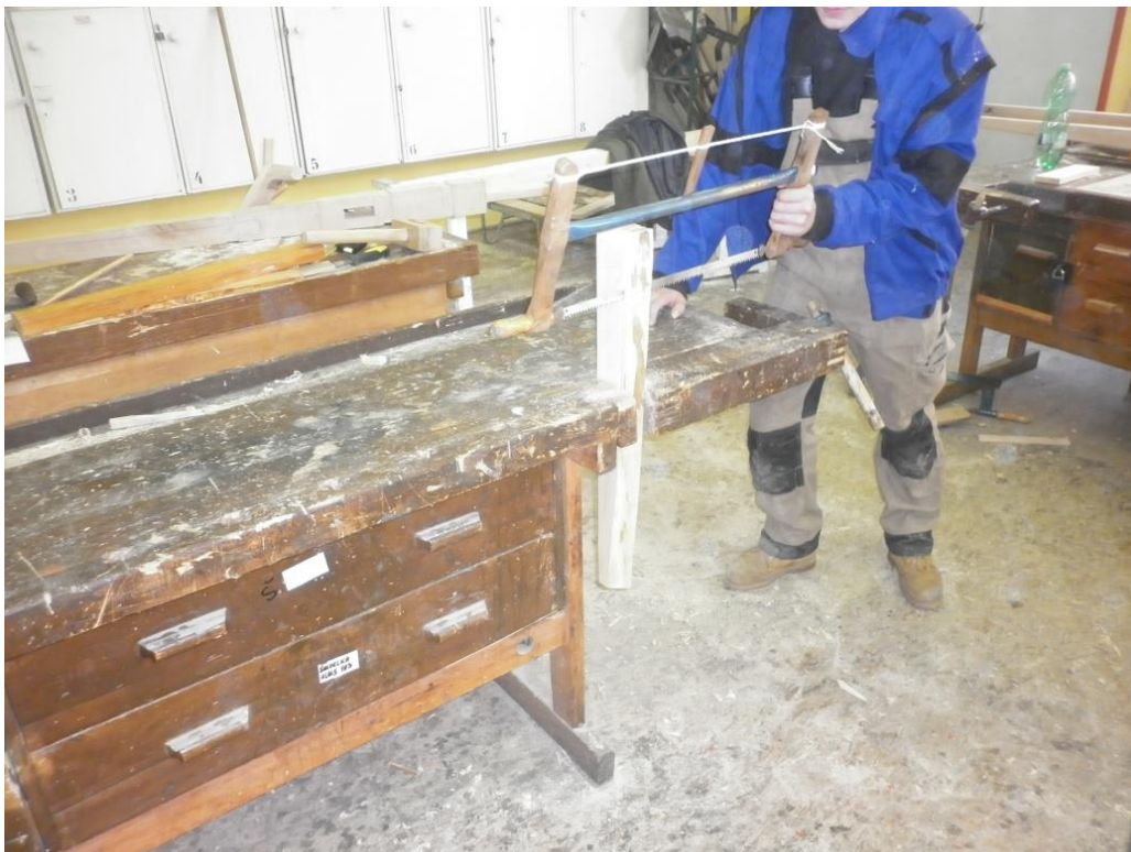
Obr 16: Postoj při vodorovném rozřezávání levorukého žáka u hoblice (vlastní tvorba)
