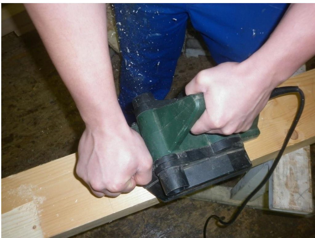
Obr 32: Držení ručního elektrického hoblíku levákem a odvod třísek (vlastní tvorba)
