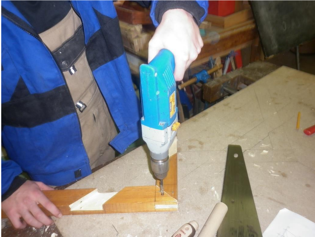
Obr 19: Držení ruční elektrické vrtačky levákem (vlastní tvorba)
