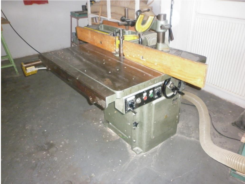
Obr 37: Spodní stolová fréza s obsluhou pravé strany (vlastní tvorba)
