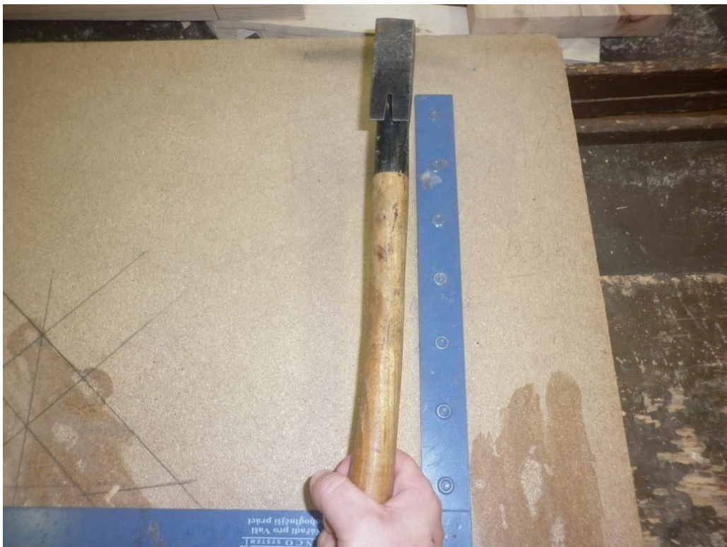
Obr 10: Sekera podbíječka při jednoručním pravostranném držení – tvar topůrka (vlastní tvorba)
