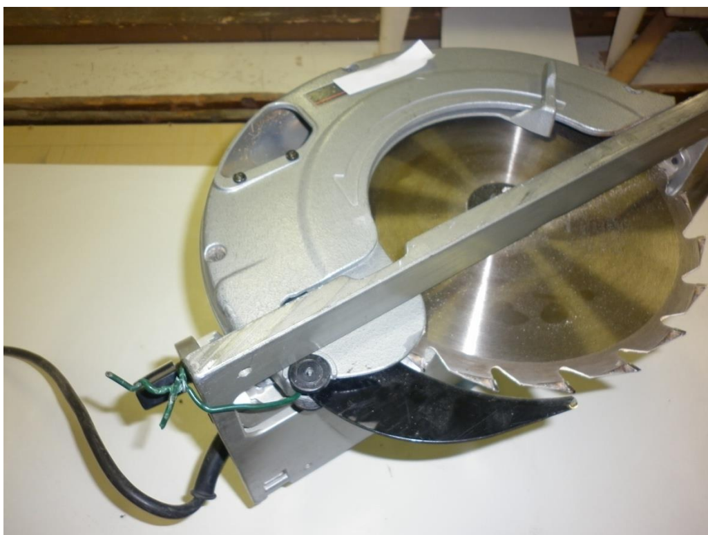
Obr 30: Úprava zajištění krytu ruční kotoučové pily (vlastní tvorba)
