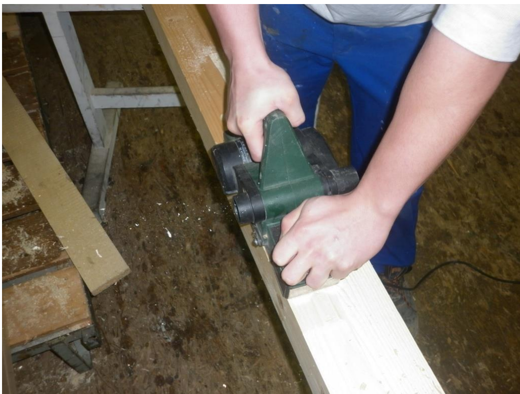
Obr 31: Držení ručního elektrického hoblíku pravákem a odvod třísek (vlastní tvorba)
