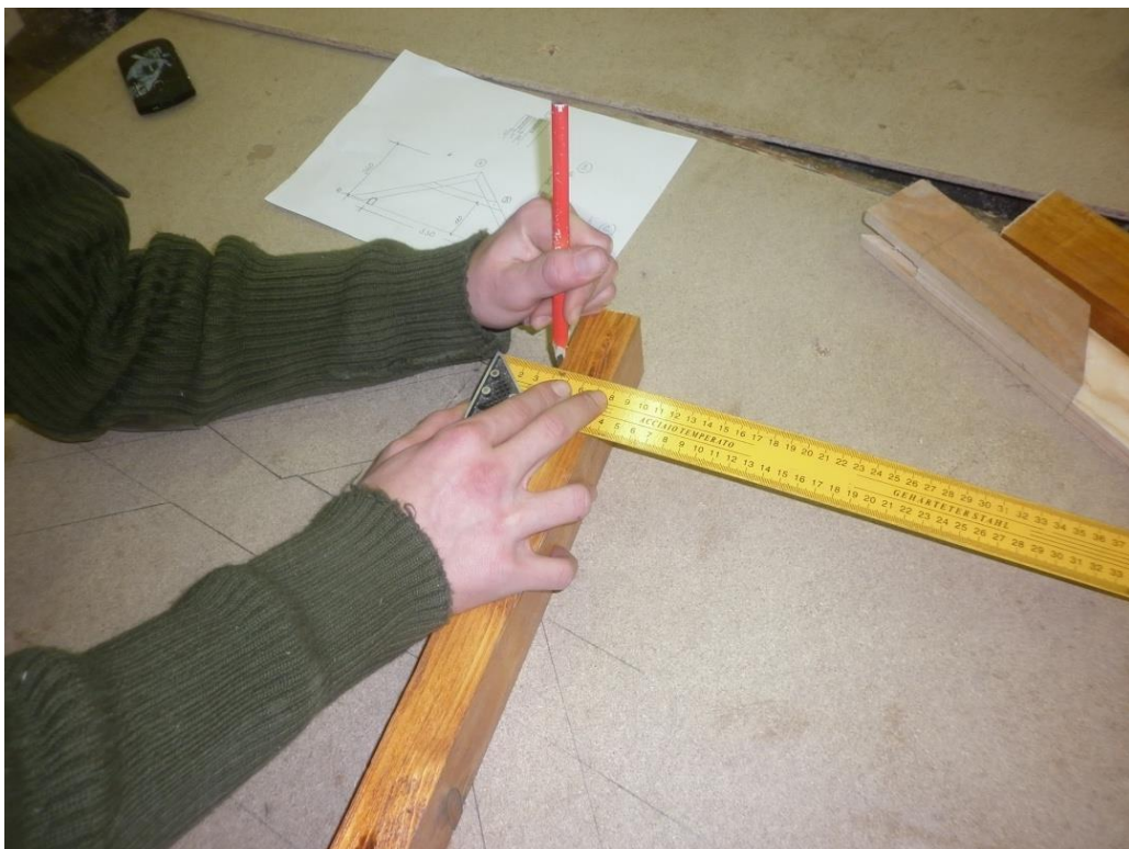
Obr 2: Práce s úhelnicí levorukého žáka (vlastní tvorba)
