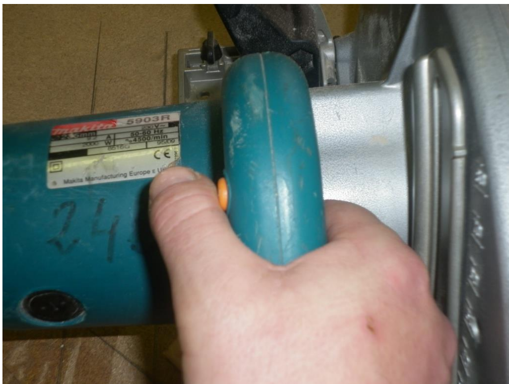
Obr 28: Přístup k ovládání praváka na ruční elektrické kotoučové pile (vlastní tvorba)
