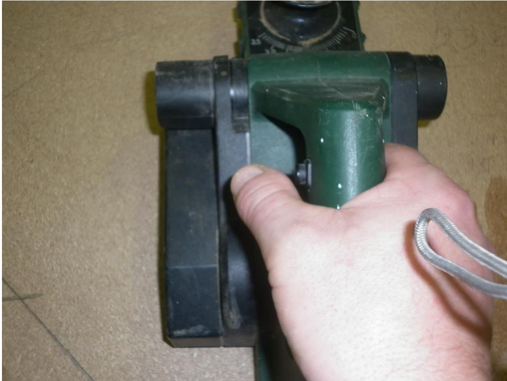
Obr 33: Přístup k ovládání praváka na ručním elektrickém hoblíku (vlastní tvorba)
