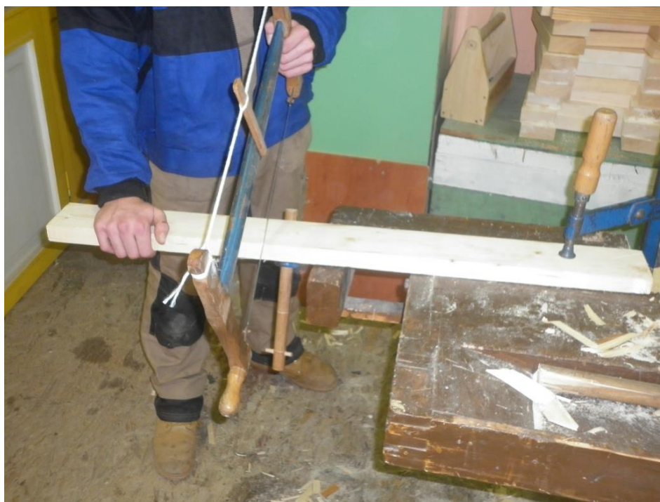
Obr 18: Postoj levorukého žáka při přeřezávání a přidržování materiálu (vlastní tvorba)
