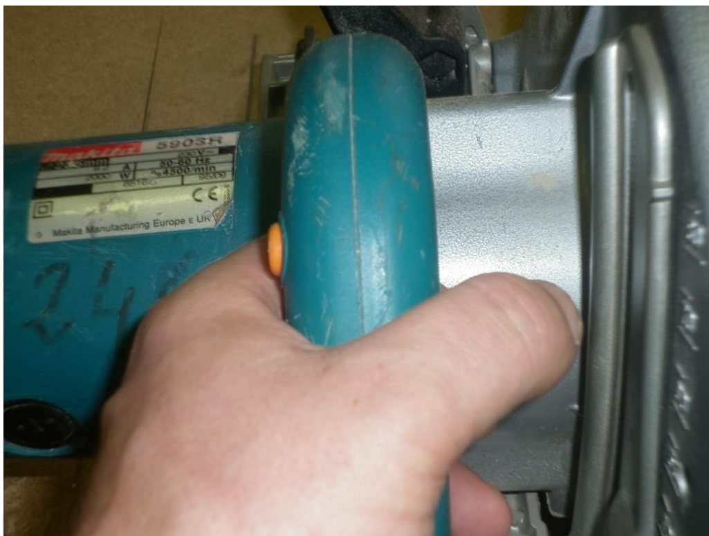
Obr 27: Přístup k ovládání leváka na ruční elektrické kotoučové pile (vlastní tvorba)
