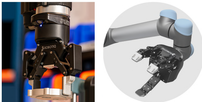
Obrázek 4.2: Příklad prstových chapadel [6]
