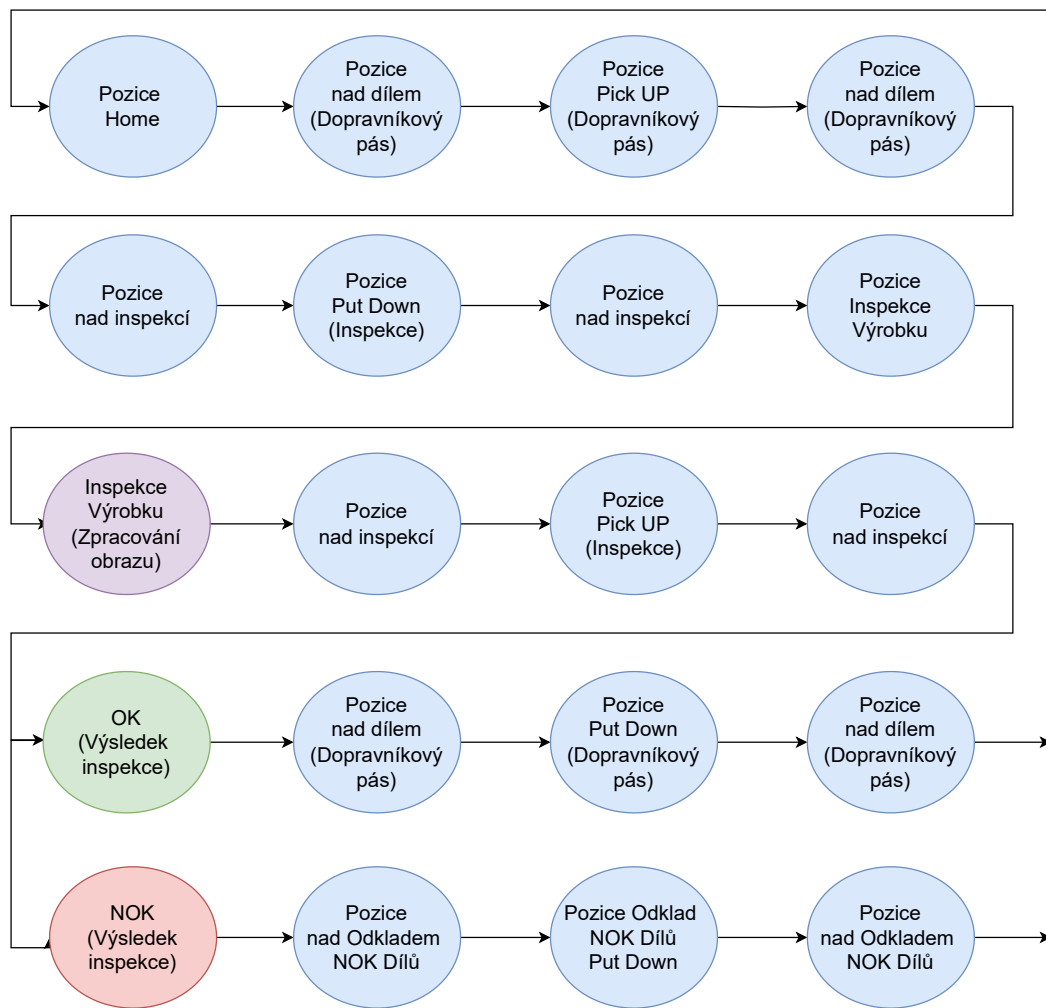
Obrázek 8.2: Flowchart pohybu robota
