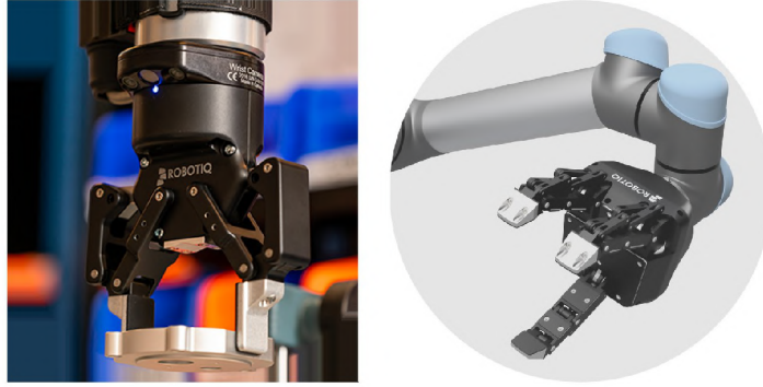
Obrázek 4.2: Příklad prstových chapadel [6]
