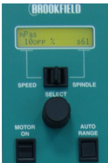
Obrázek 4.3: Detail přední desky rotačního viskozimetru
