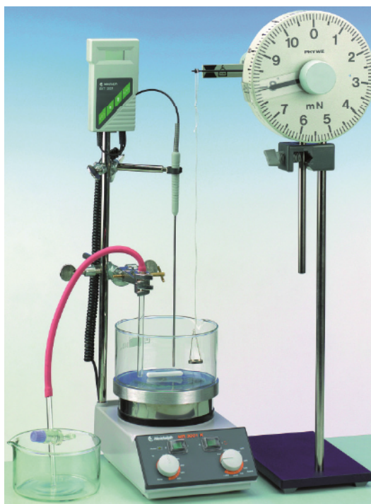
Obrázek 3.3: Ilustrační fotografie sady na měření povrchového napětí
