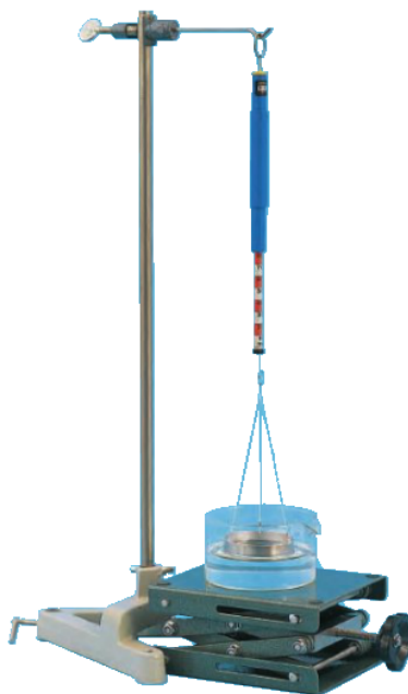
Obrázek 3.5: Ilustrační obrázek sestavy na měření povrchové napětí kapalin
