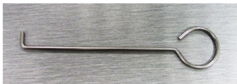
Obrázek 6.7: Kovový háček pro vyjmutí stavebního materiálu
