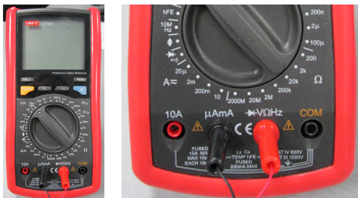
Obrázek 5.7: Multimetr UNI-T UT76A a zapojení teplotního čidla
