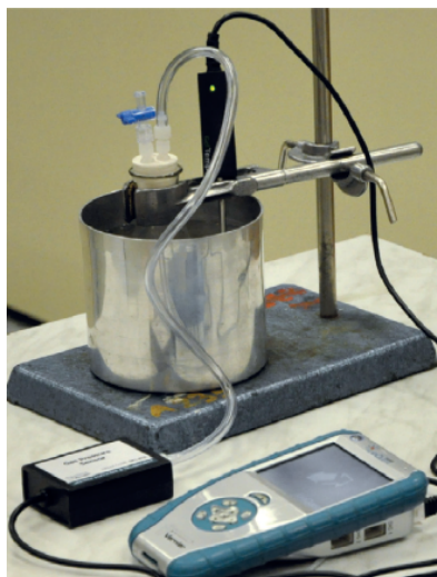
Obrázek 5.3: Sestava pro ověřování stavové rovnice ideálního plynu s čidly od firmy Vernier [9]
