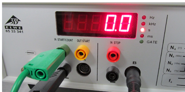
Obrázek 2.2: Zapojení čítače při měření
